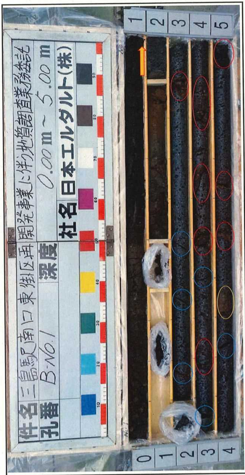
写真 5.1 B-No.1 深度 1.90~5.00m の玄武岩コア写真
