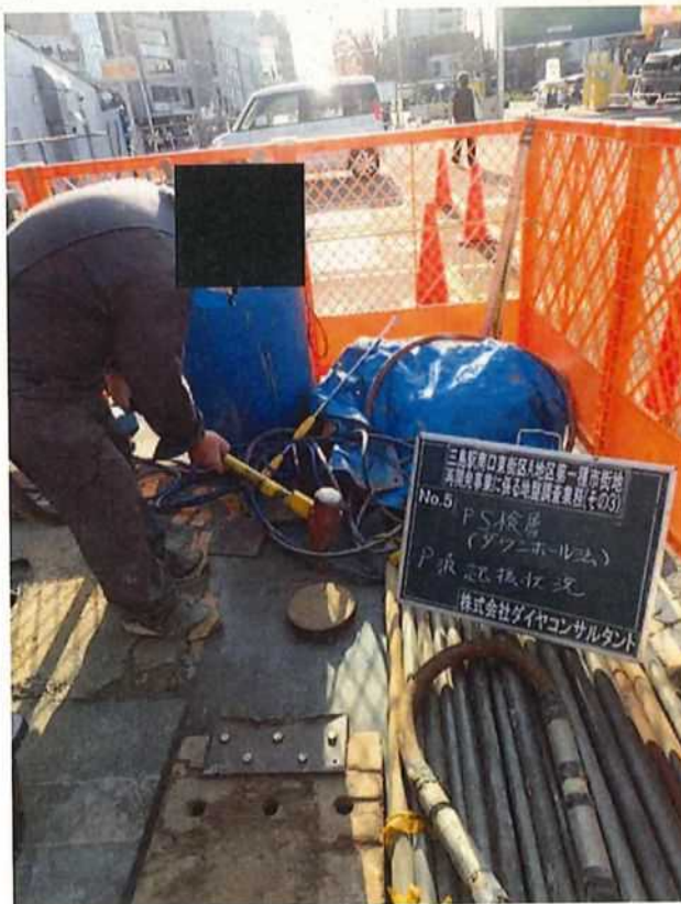
ダウンホールPS検層 P波起振状況
