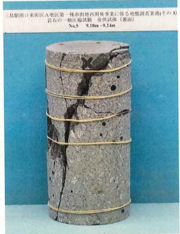
No.5 GL-9.10~9.24m : 試験後供試体(裏面)
