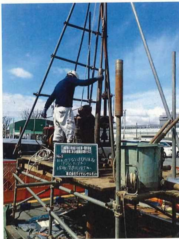
乱れの少ない試料採取 デンソン式サンプリング GL-18.50m~
