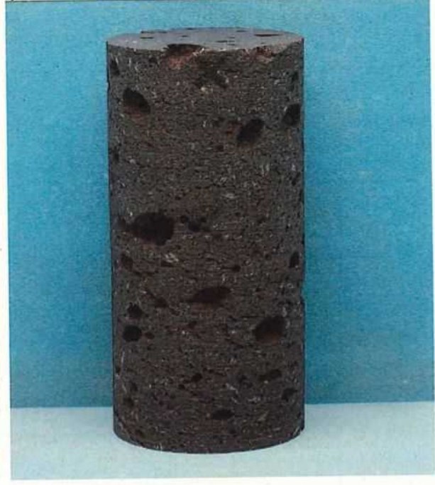
No.5 GL-12.49~12.63m : 試験前供試体(裏面)
