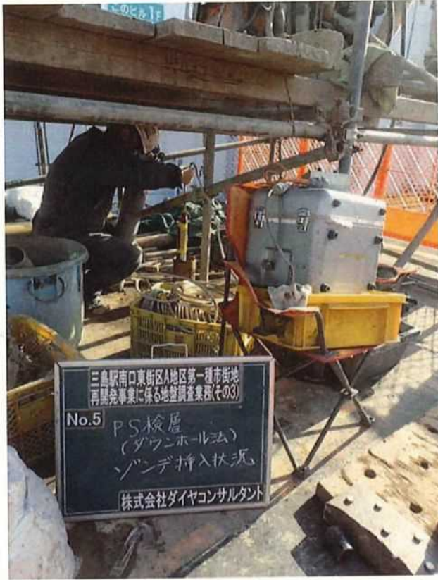
ダウンホールPS検層 ゾンデ挿入
