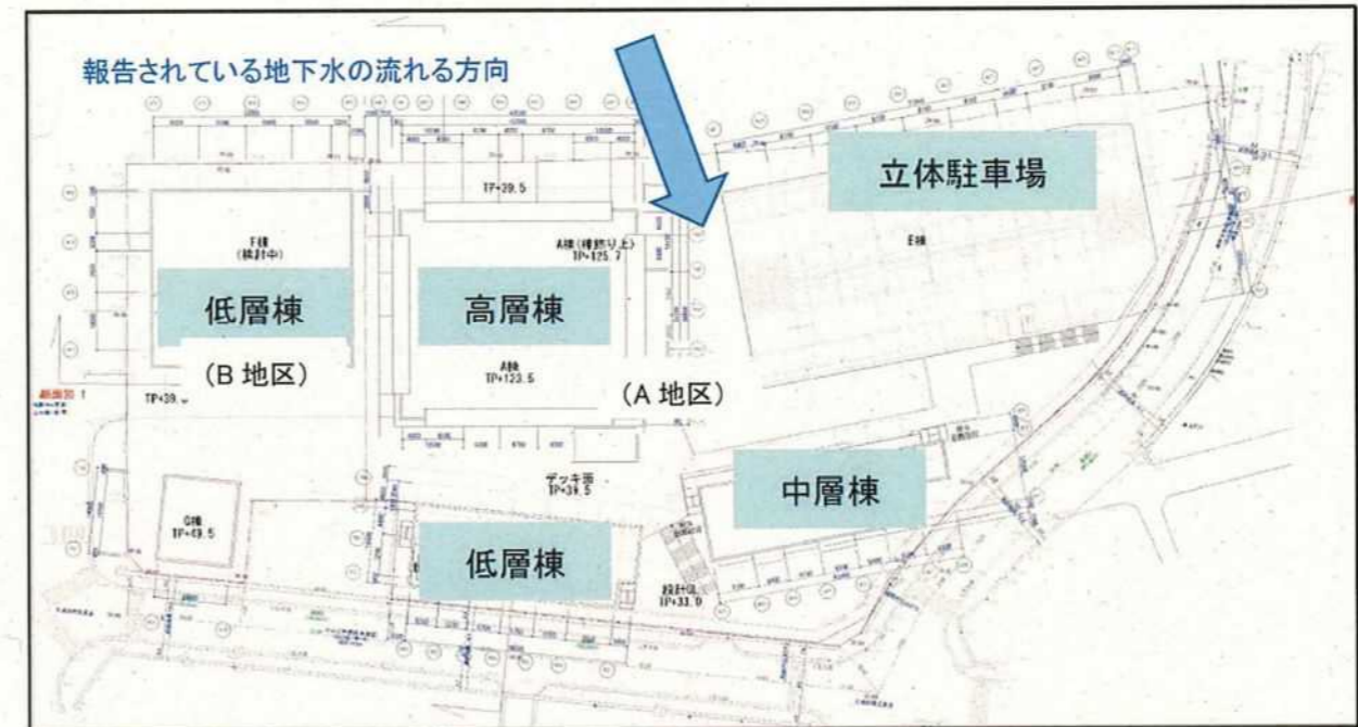
図: 建物配置と地下水の流れる方向
